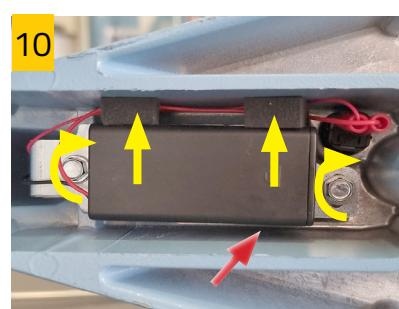
Servendosi del cacciavite a taglio diritto **agire sul supporto in lamiera per ruotare l'inclinazione** fino ad allineare la linea del laser alla linea di taglio. Serrare le due viti, inserire le spugnette.
