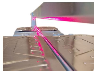
Appuyez sur le support en tôle avec le tournevis droit pour faire pivoter l'inclinaison jusqu'à ce que la ligne laser soit alignée avec la ligne de coupe. Serrez les deux vis et insérez les éponges. Collez l'étiquette du laser sur la base à proximité du bouton (fig. 11).
