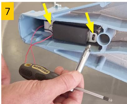
Servendosi della chiave a tubo e del cacciavite avvitare completamente le due viti con rondella, una volta montate svitarle entrambe 1/4 di giro per la regolazione.
